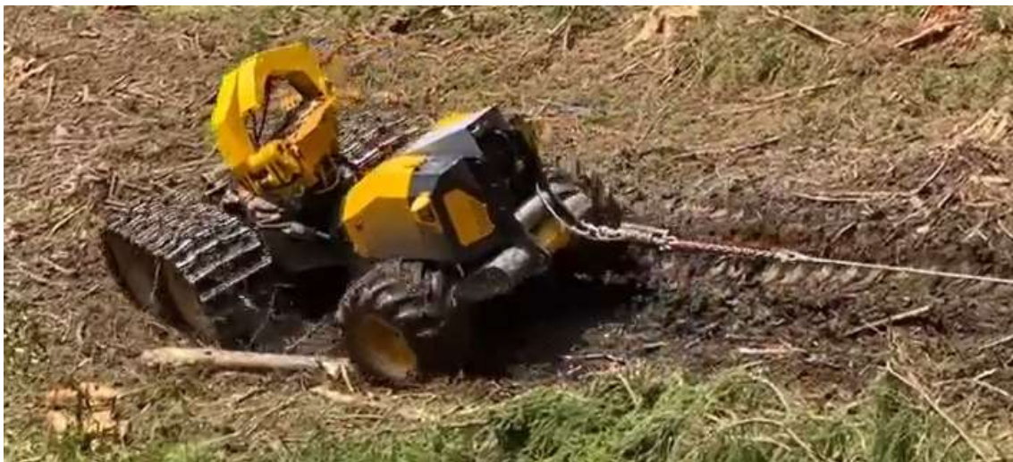
Рис. 15. Трелевочная тележка компании Konrad Forsttechnik GmbH в непогруженном положении
