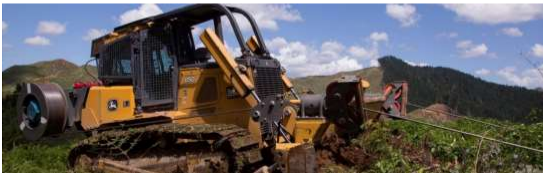
Рис. 13. Самоходная лебедка на бульдозерной базе ROV
