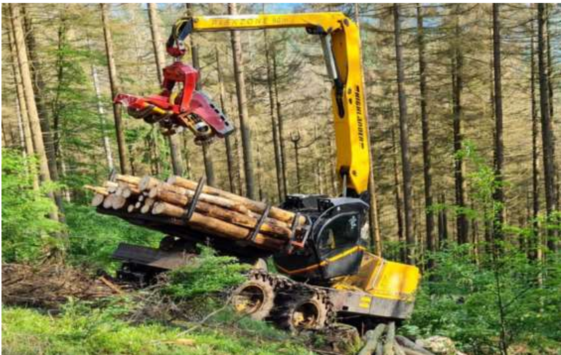
Рис. 10. Харвардер на базе «Highlander» компании Konrad Forsttechnik GmbH
