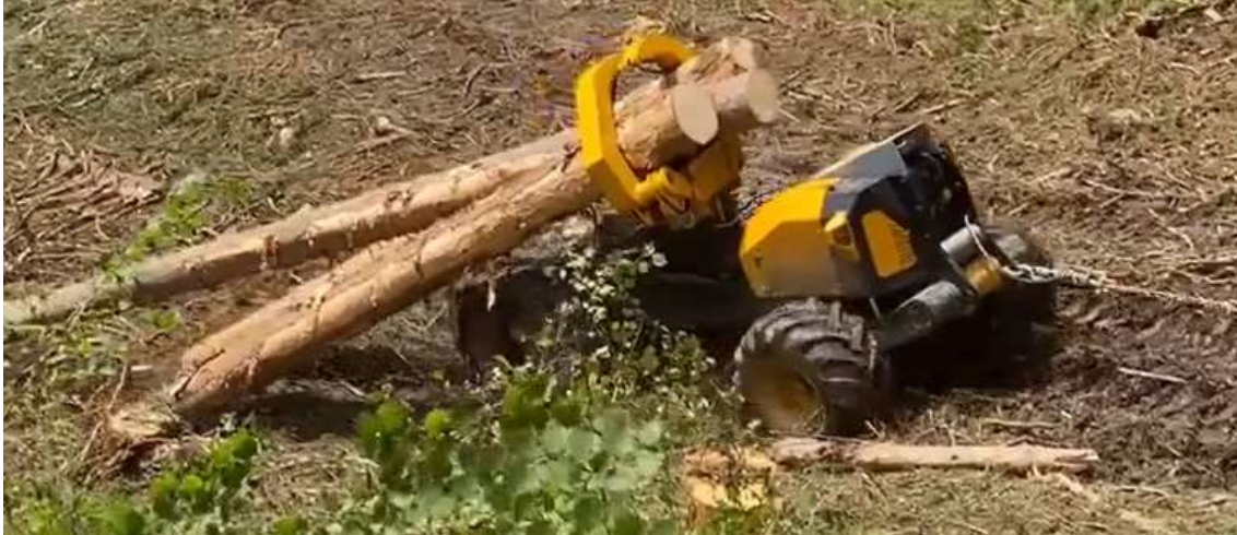
Рис. 16. Трелевочная тележка компании Konrad Forsttechnik GmbH в погруженном положении
