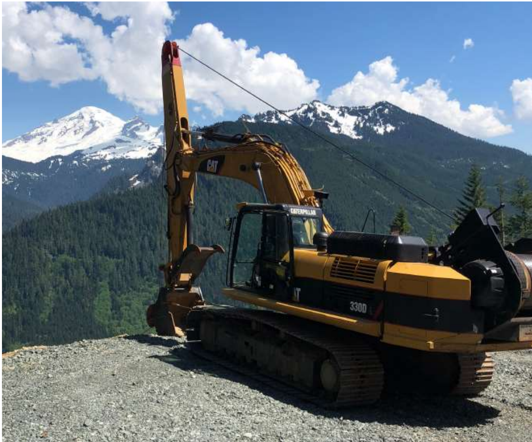
Рис. 12. Самоходная лебедка на экскаваторной базе Summit Winch Assist
