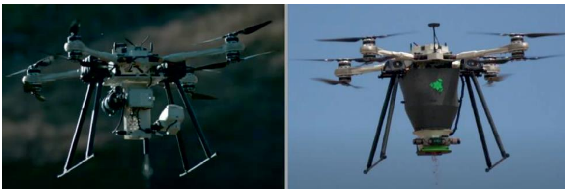
Рис. 3. Высевающий комплекс на базе БПЛА «мультикоптер»
