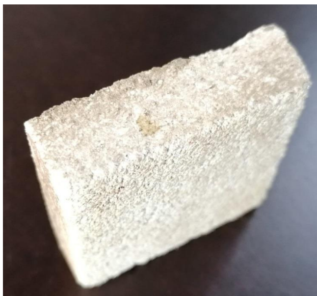
Рис. 6. Фрагмент термопластбетона, получаемого на основе древесной шлифовальной пыли
