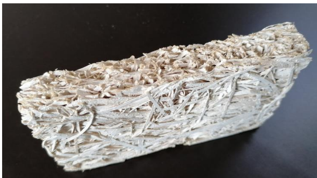
Рис. 5. Фрагмент термопластбетона, получаемого на основе древесной стружки
