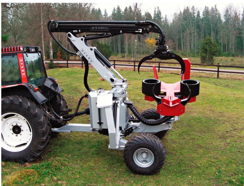
Рис. 4. Легкий самоходный процессор, работающий от вала отбора мощности небольшого трактора
