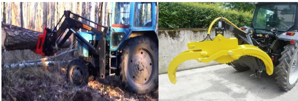
Рис. 1. Легкий штабелер на базе трактора МТЗ с бревнозахватом для протаскивания деревьев через делимбер
